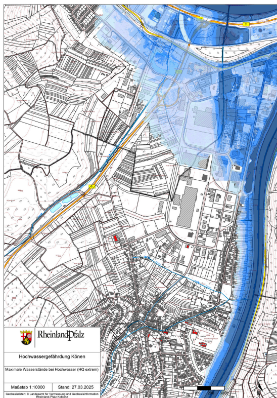
Auszug Hochwassergefahrenkarte (Könn-Könn) mit max. Wassertiefen bei einem simulierten extremen Hochwasserereignis (HQextrem)
