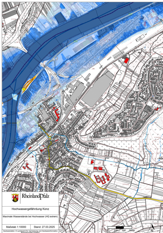
Auszug Hochwassergefahrenkarte des Landes mit max. Wassertiefen bei einem simulierten extremen Hochwasserereignis (HQextrem)
